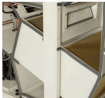
Hoog rendement (95%) aluminium kruisstroomwarmtewisselaar voorzien van epoxy coating bestand tegen de agressieve chloorhoudende zwembadlucht.
